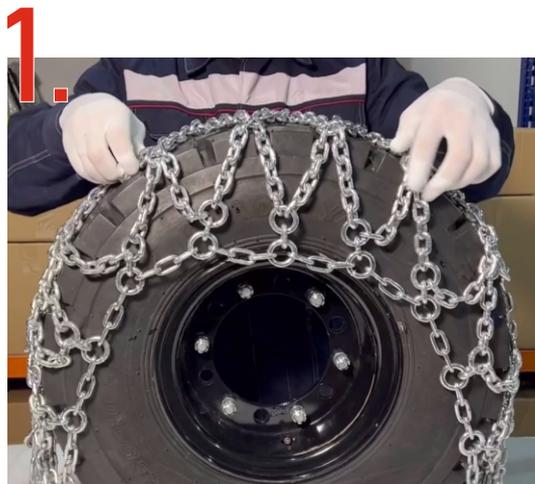
1. Транспортное средство закрепить в положении, исключающим произвольное движение по дороге. Накинуть цепь противоскольжения на колесо таким образом, чтобы кольца для натяжки находились с наружной стороны колеса а запорные крюки и хвостовые звенья находились в нижней части колеса. Расправить поперечные ветви равномерно по окружности колеса.
